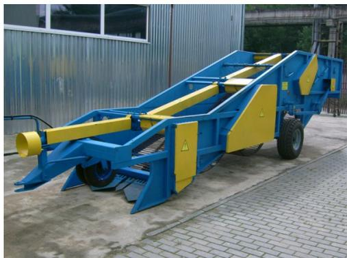
Машина предназначена для работы на всех видах почв, в том числе на суглинках и тяжелых почвах при ее влажности до 27%, а так же может быть применена на почвах средnezасоренных камнями до 6т/га размером не более 150 мм. Машина работает на гладких и гребневых посадках с междурядьями 70 см. Агрегатируется с тракторами класса 1,4 КН.
