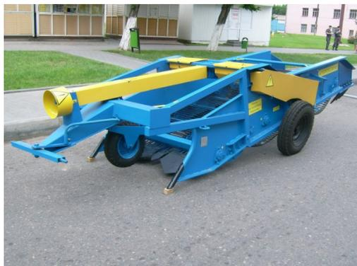
**Картофелекопатель КСТ-1.4М** оснащен каскадным элеватором и активным битером. В переводе на человеческий язык, он легко разбивает верхний пласт, тщательно отсеивает посторонние включения и хорошо очищает корнеплоды от налипшей земли, предотвращая вынос почвы с поля.
