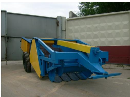
**Картофелекопалка КСТ 1.4** — простой и быстрый способ собрать урожай с фермерских плантаций клубневых культур. Она обеспечивает равномерное вскапывание почвы и частичное отделение клубней от земли.
