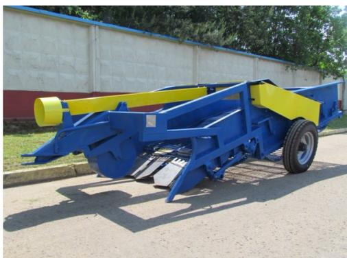
**Картофелекопатель полунавесной двухрядный КСТ-1,4М-02** предназначен для выкапывания картофеля частичного отделения клубней картофеля от почвы и укладывания их на поверхность поля для дальнейшей подборки.
