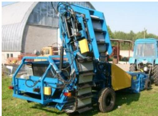
**МУЛС-1,4** — предназначен для **уборки лука-севка**. Транспортное средство используют как на однофазной так и на двухфазной схеме уборки лука.
