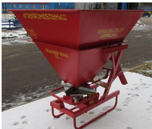
**Разбрасыватель минеральных удобрений А — 116** предназначен для поверхностного внесения твердых минеральных удобрений в гранулированном и кристаллическом виде с последующей заделкой их почвообрабатывающими орудиями, а также подкормку озимых культур, пропашных лугов и пастбищ.
