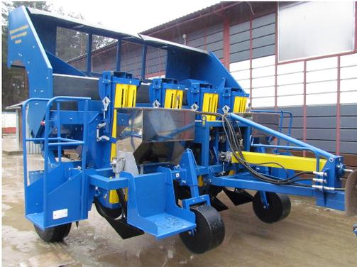
**Картофелесажалка КСМ 4** — полунавесная четырехрядная модель, предназначена для автоматизации процесса посадки картофеля. При помощи этого оборудования можно быстро засадить поле большой площади, при этом клубни закладываются с одинаковым интервалом и на равную глубину.
