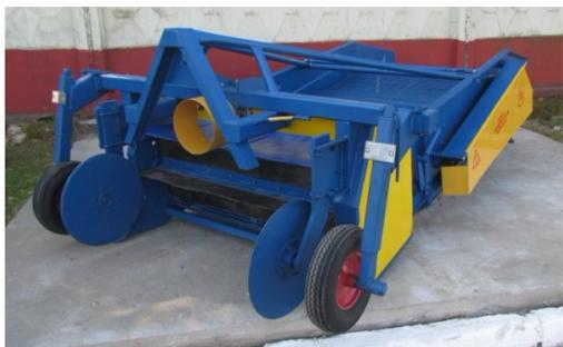
Для перекапывания лукового поля компанией ЗАО “Агропромсельмаш” разработана специальная сельхозтехника — копатель-валкоукладчик лука **КЛ 1.4А**. Он работает с междурядьями шириной 28,45 и 70 см.
