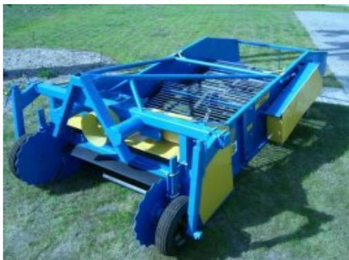
Копатель-валкоукладчик лука-севка **КЛ-1.4А** — это универсальная сельхозтехника для сбора урожая с лукового поля. Он обеспечивает бережное снятие верхнего слоя почвы, полностью исключая повреждение луковиц.
