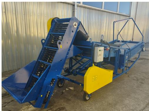
**Машина для сортировки овощей МСО-1** предназначена для калибрования клубней на 3 фракции с последующим затариванием в сетки или подачей на транспортеры.
