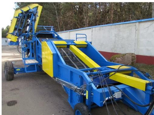
Быстро собрать, рассортировать и очистить от остатков почвы лук поможет подборщик лука ПЛ-1. Он захватывает тонкий пласт земли, на котором лежат уже выкопанные при помощи копателя-валкоукладчика луковицы, пропускает их через специальный элеватор, и поставляет прямо на стол сельхоз рабочего.
