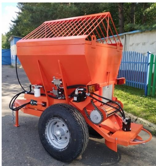
**Разбрасыватель песка А-415** предназначен для разбрасывания песка и песчано-солевых смесей по тротуарам и пешеходным зонам шириной не менее 1,8 м по ширине твердого покрытия, 2,5 м по ширине расположения насаждений, фонарей, столбов и др. предметов, не менее 3 м от оси движения трактора до стен зданий и сооружений, на которое не допускается попадание разбрасываемого материала.
