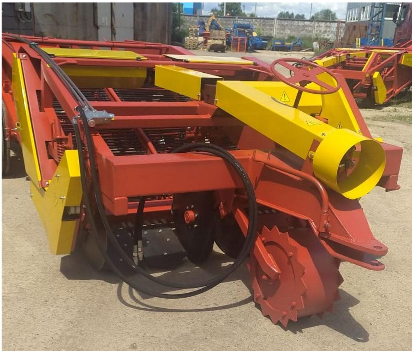
Копатель-валкователь универсальный УКВ-2 на междурядье 90 см., предназначен для одновременного выкапывания клубней картофеля из двух рядков, частичного отделения клубней от почвы и растительных остатков и укладки их в валок в междурядье расположенных рядом неубранных рядков для последующего подбора картофелеуборочным комбайном.
